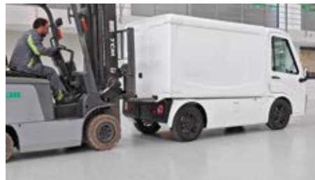
1 Einfach mit einem Gabelstabler Cargo-Boxen wechseln
