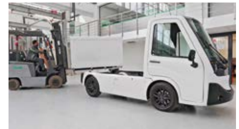
2 Für schnelle Umschlagszeiten können Cargo-Boxen gelagert und vorbereitet werden
