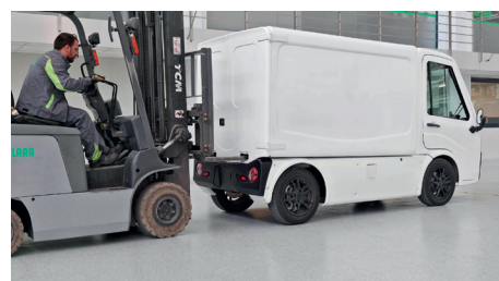
1 Лесна смяна на нагстройка с мотокар.
